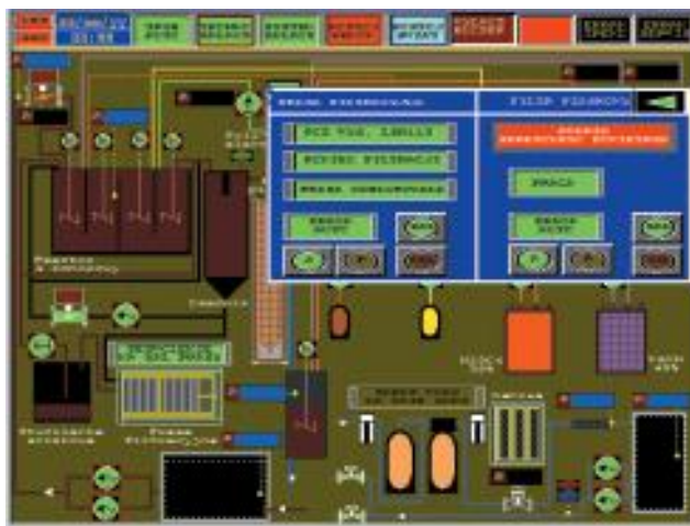
Widok ekranu głównego i okna urządzeń w oczyszczalni ścieków
