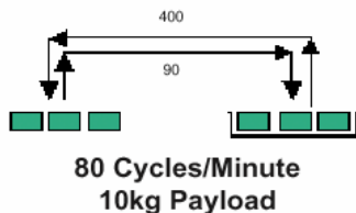
Rys. 2. Cykl pracy dla wybranych zadań paletyzacji wykonywanych przez robota M- 410i.
